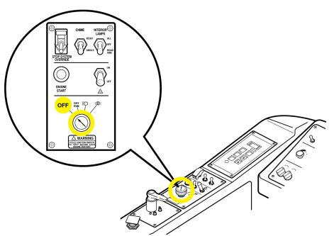
TURN **OFF BATTERY** DISCONNECT SWITCH (FRONT DRIVER SIDE)
